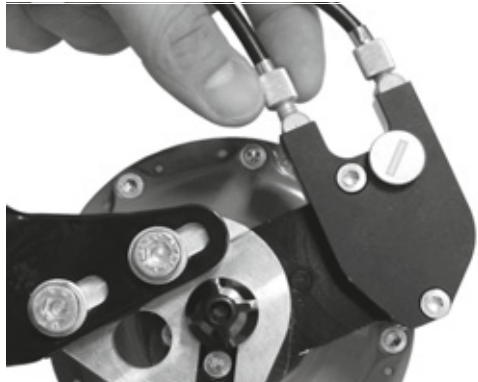
Obr. 123: Náboje Rohloff s externím ovládním řazení mají seřizovače napnutí na lanovodu, který je umístěn na levé straně
