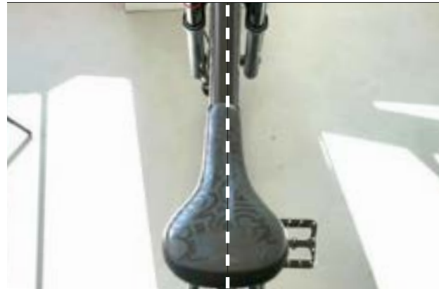
99. ábra: Nyereg beállítása menetirányban
