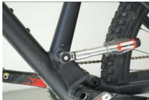
100. ábra: A nyeregcsőtengely meghúzása
