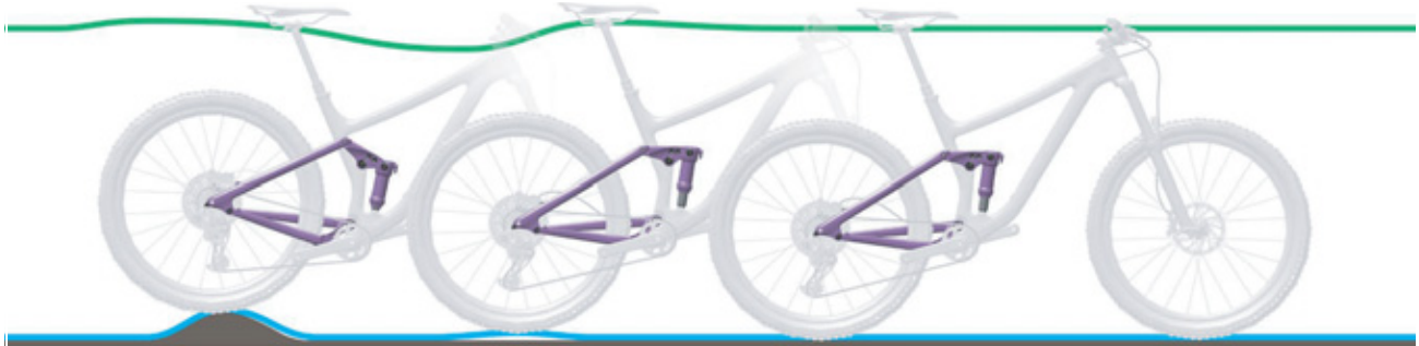
221. ábra: A hátsó lengéscsillapító túl gyors kirugózása
