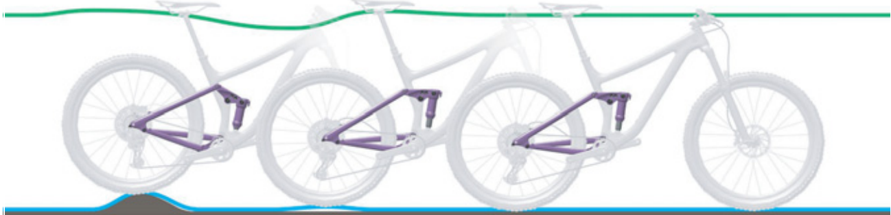
213. ábra: A hátsó lengéscsillapító túl gyors kirugózása
