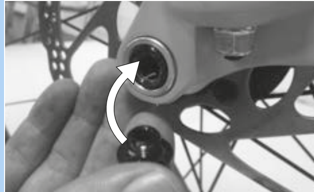
67. ábra: Rögzítőcsavar beszerelése
