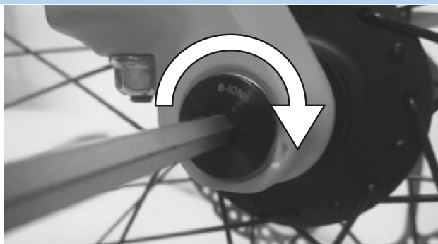
66. ábra: A tengely meghúzása nyílirányban
