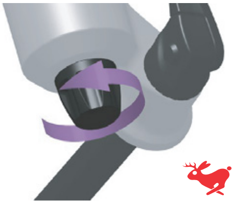
208. ábra: A húzófokozat csavar fordítása a nyúl irányába
