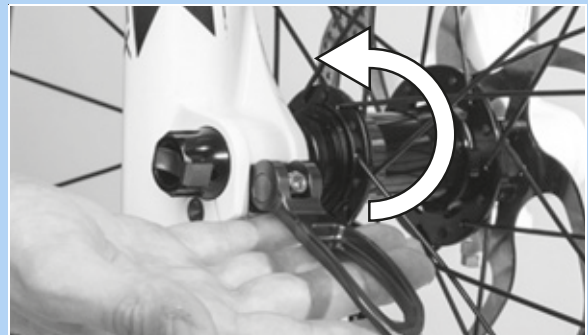
72. ábra: A gyorszár nyomása nyílrányban
