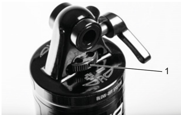
214. ábra: SR SUNTOUR kerék-húzófokozat-beállító (1) a hátsó lengéscsillapítón
