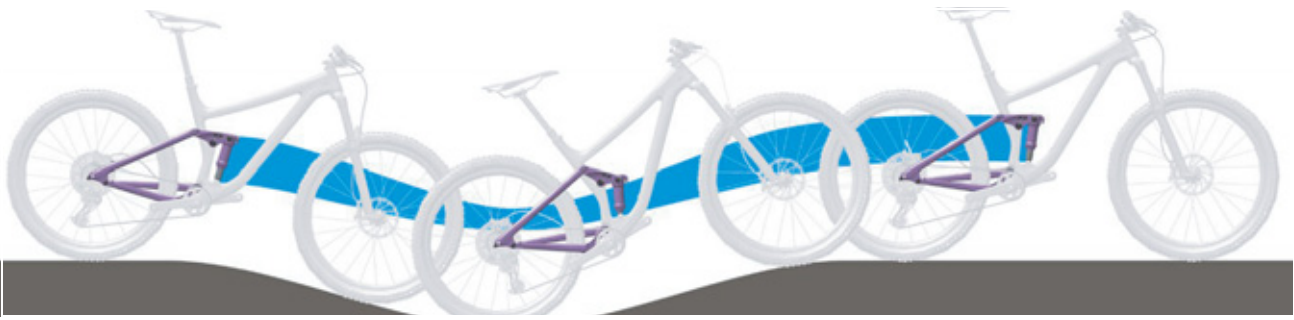
217. ábra: A hátsó lengéscsillapító túl puha rugózása hegymenetben
