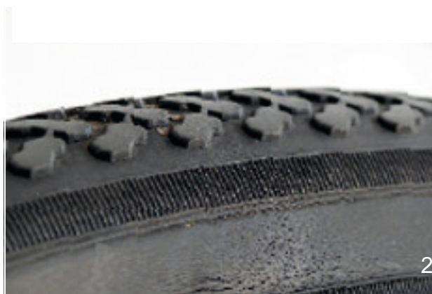
163. ábra: Példák kifáradási repedésekre (1) és öregedési repedésekre (2)
