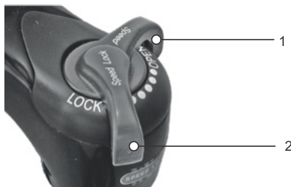
Illustration 62 : Amortisseur de compression Suntour en position ouverte (1) et fermée (2)
