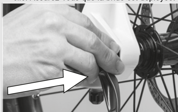
Illustration 30 : Enfoncer l'attache rapide
