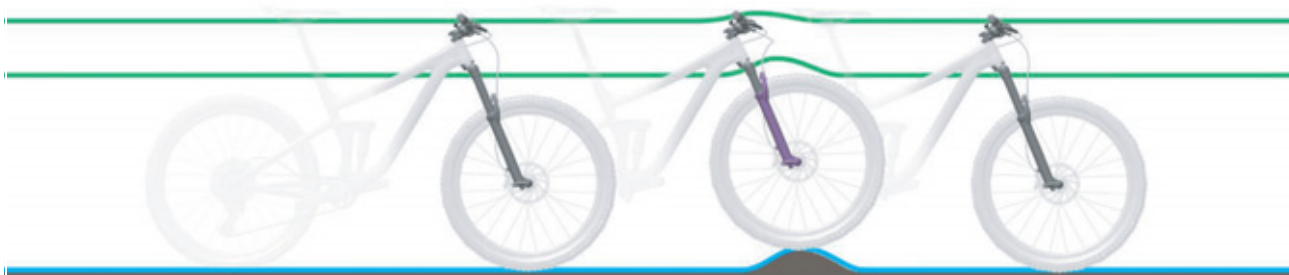
Illustration 61 : Comportement optimal sur les irrégularités
