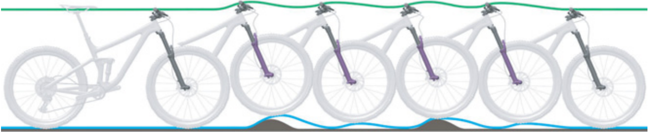
Illustration 70 : Détente trop rapide de la fourche de suspension
