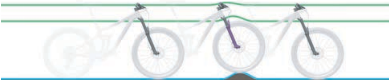
Abbildung 10: Optimales Fahrverhalten der Gabel bei Unebenheiten
