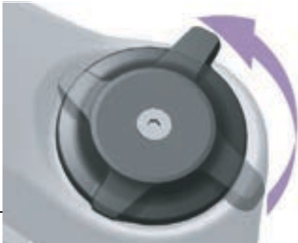
Abbildung 150: Druckstufeneinsteller weicher einstellen
