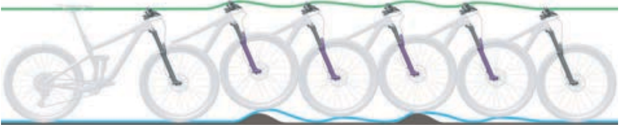
Abbildung 240: Zu schnelles Ausfedern der Federgabel
