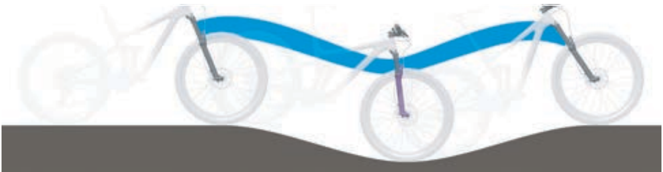
Abbildung 9: Optimales Fahrverhalten der Gabel im hügeligen Gelände
