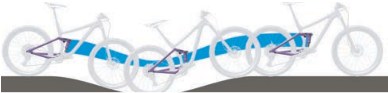
Abbildung 260: Zu weiche Federung des Hinterbau-Dämpfers am Berg
