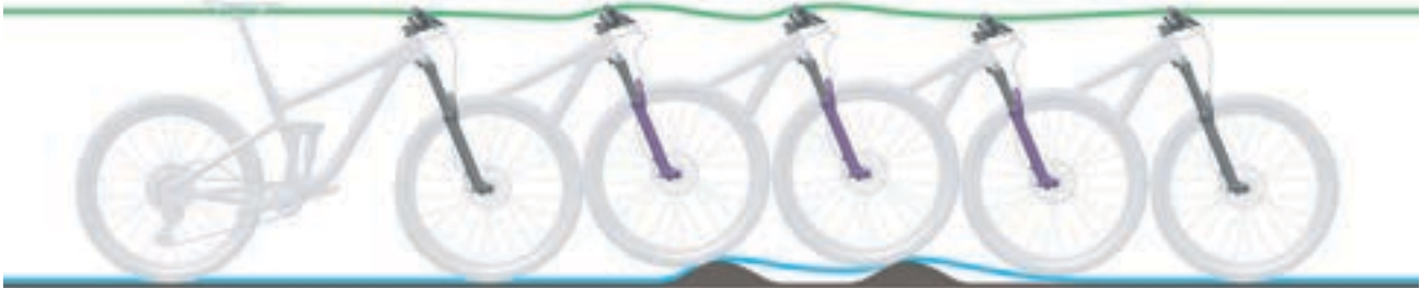
Abbildung 242: Zu langsames Ausfedern der Federgabel
