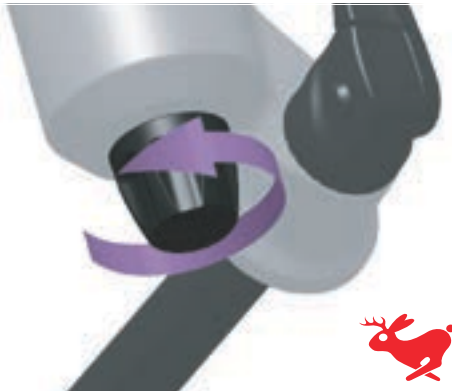
Abbildung 243: Zugstufen-Schraube in Richtung Hase drehen
