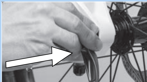
Abbildung 65: Schnellspanner in Pfeilrichtung einschieben
