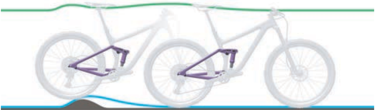
Abbildung 254: Zu harte Dämpfung des Hinterbau-Dämpfers bei Unebenheiten
