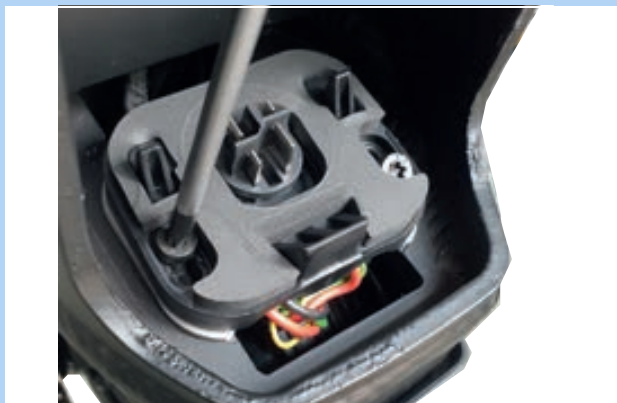
Abbildung 49: Akkuhalter Schrauben lösen
