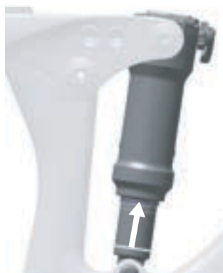
Abbildung 115: O-Ring am Hinterbau-Dämpfer verschieben
