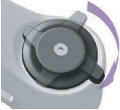
Abbildung 149: Druckstufeneinsteller härter einstellen
