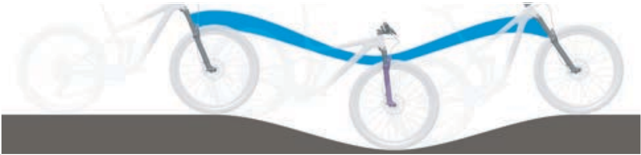
Abbildung 236: Zu weiche Federung der Federgabel am Berg
