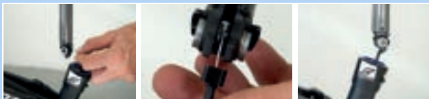
Abbildung 228: Sattelstütze aufhängen und einschieben
