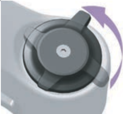
Abbildung 247: Druckstufeneinsteller weicher einstellen
