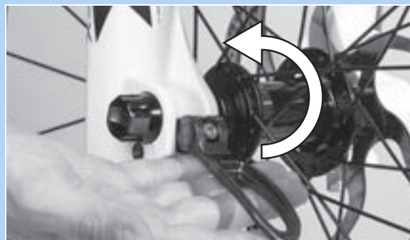
Abbildung 61: Schnellspannhebel in Pfeilrichtung drücken
