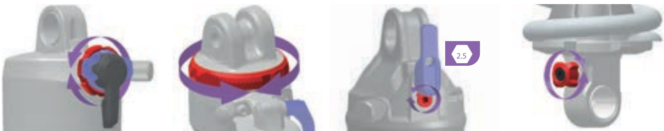
Abbildung 259: Lage und Form des Zugstufeneinstellers (rot) ist Modellabhängig
