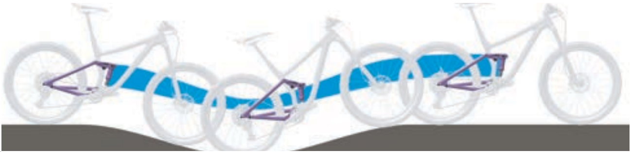
Abbildung 252: Zu weiche Federung des Hinterbau-Dämpfers am Berg
