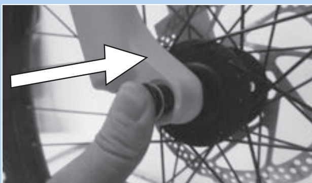
Abbildung 54: Achse in Pfeilrichtung einschieben
