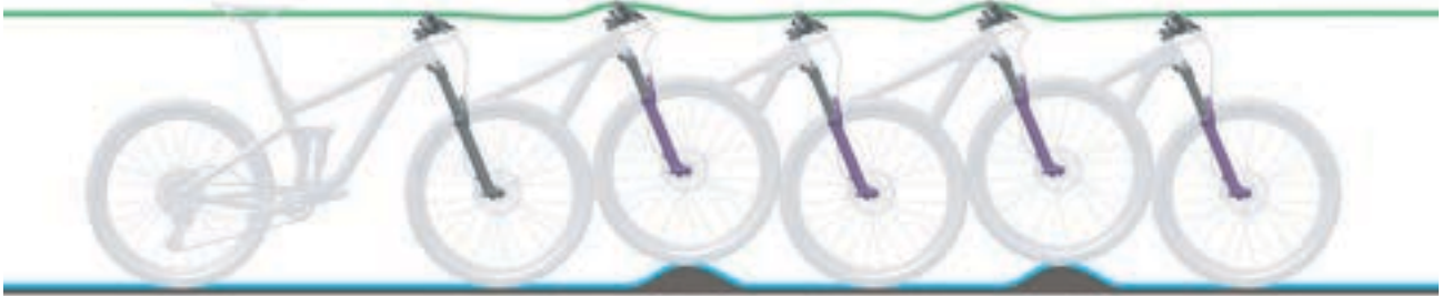
Abbildung 8: Optimales Fahrverhalten der Gabel
