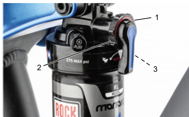
Afbeelding 77: Hardheid van de trekdemper afstellen met het afstelwiel (1) van de achterbouwdemper
