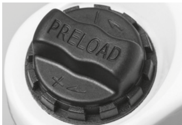
Afbeelding 56: Afstelwiel voor de negatieve veerweg op de kroon van de verende voorvork
